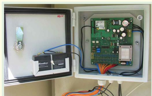
Терминал пункта включения является специализированным устройством, разработанным для выполнения задач автоматизации объектов городского освещения.
