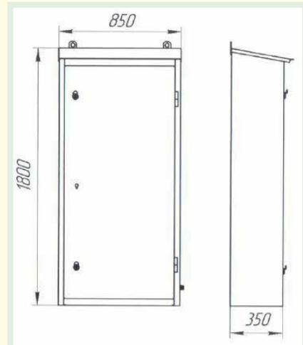
**Шкафы управления уличным освещением И-710 предусматривают возможность управления четырьмя группами наружного освещения (согласно ДБН.2.5-28):**
