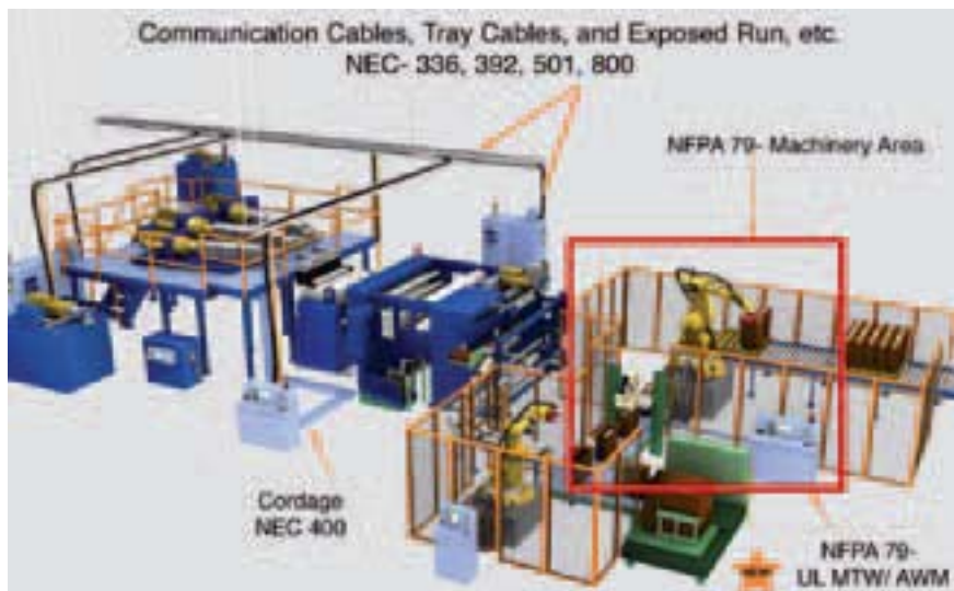
Пример применения кабелей и проводов по стандартам NEC® и NFPA, 'NEC®' это фирменный знак National Fire Protection Association.
