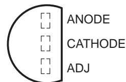
LM336-2.5, LM336B-2.5 . . . LP PACKAGE (TOP VIEW)
