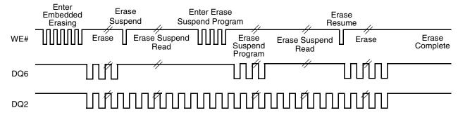
**Note:** The system may use OE# and CE# to toggle DQ2 and DQ6. DQ2 toggles only when read at an address within an erase-suspended sector.
