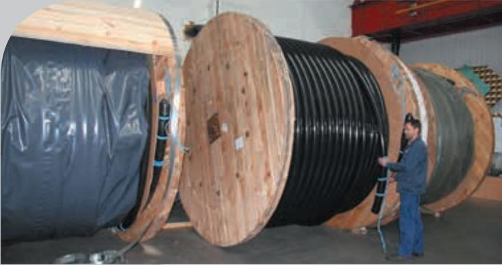
По заказу энергетического холдинга ДТЭК завод «Южкабель» изготовил и поставил сверхвысоковольтный силовой кабель с изоляцией из сшитого полиэтилена на напряжение 330 кВ для Криворожской ТЭС (г. Зеленодольск).
