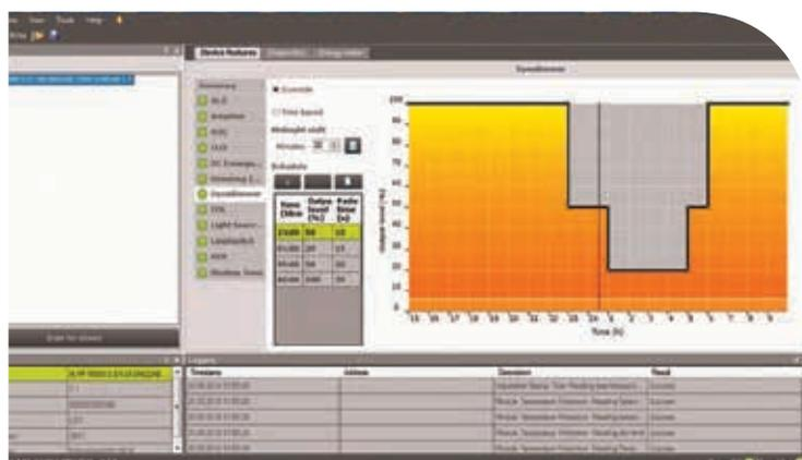
Рис. 2. Временной график регулирования уровня освещенности (мощности)
