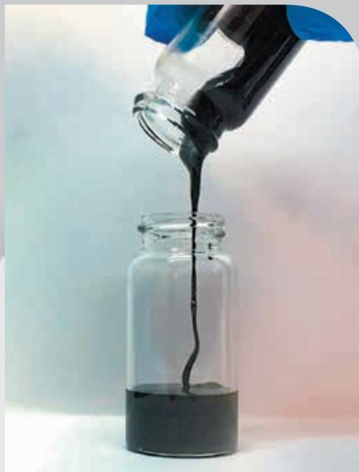
цы лития равномерно распределены по всей поверхности. Матрица остается текучей при комнатной температуре, что позволяет ей создавать достаточный уровень контакта с твердым электролитом. Комбинируя полужидкий металлический анод с твердым керамическим электролитом на основе граната, они смогли задействовать элемент в 10 раз более высокой плотности тока, чем элементы с твердым электролитом и традиционным анодом из литиевой фольги.
