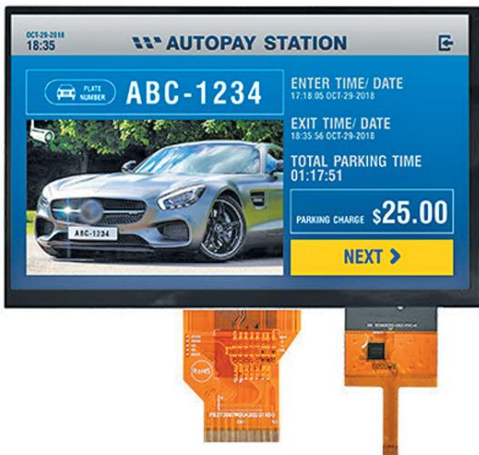
**WF70A2SIAGDNG0** – це 7-кільоворовий TFT модуль з роздільною здатністю WVGA 800x480 пікселів і ємнісною тач панеллю. Дисплей має вбудований контролер IC ST-5623 з підтримкою RGB інтерфейсу і володіє високою яскравістю 700 кд/м<sup>2</sup> PCAP. Ємнісна сенсорна тач панель має вбудований контроллер FT5426 з підтримкою I2C інтерфейсу.
