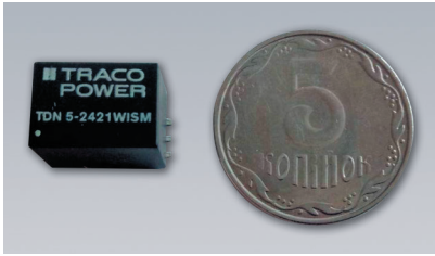
Рис. 3. Преобразователь серии TDN в сравнении с монетой номиналом 5 копеек
