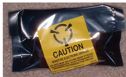
Рисунок 2 Пример маркировки электростатически чувствительного устройства
