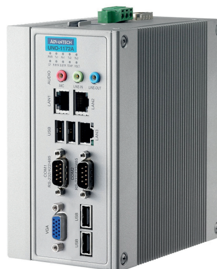
Рис. 4. Персональный компьютер UNO-1172AH на платформе Intel Atom, предназначенный для работы в суровых условиях, имеет инновационные функции диагностики системы.
