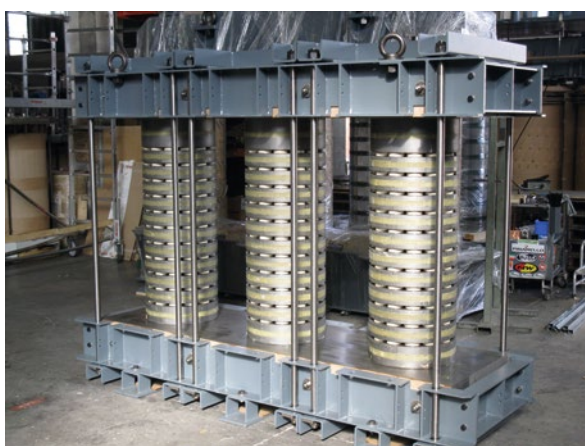
■ Пример магнитопровода с воздушными зазором
