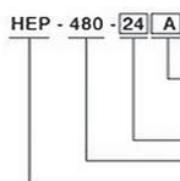
Тип А: стандартная модель, IP65, подстройка выходного тока и напряжения встроенным потенциометром
