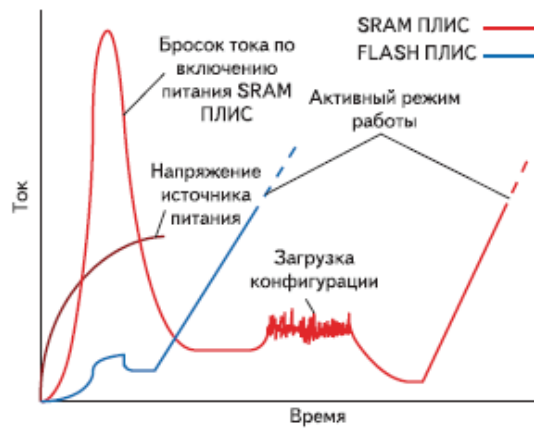
Рис. 2. График потребления тока при включении питания для ПЛИС на основе технологии Flash и SRAM
