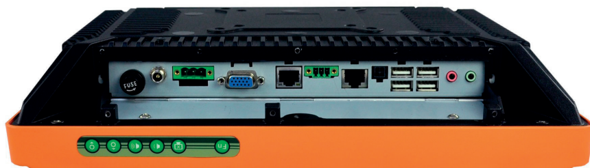
Рис. 5. UPC-V312-D525 оснащен двухдиапазонным адаптером беспроводной связи Wi-Fi, беспроводным адаптером Bluetooth и модулем системы позиционирования GPS. На задней панели расположены 4-пиновый разъем RS-422/485, разъем RS-232 (DB-9), 3-пиновый терминальный разъем шины CAN, разъем RJ-45 для подключения к локальной сети, четыре порта USB 2.0 и др.
