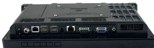
Рис. 3. Панельный компьютер AFL2-12A-D525 можно использовать не только в промышленности, но и для задач управления в системах «Умный дом» как внутри помещений, так и на открытом воздухе. На его задней панели расположены два порта RS-232 (разъемы DB-9 и RJ-45), 4-пиновый разъем RS-422/485, два порта RJ-45 для подключения к локальной сети и четыре порта USB 2.0
