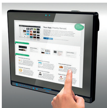
Рис. 3. Панельный компьютер AFL2-12A-D525 можно использовать не только в промышленности, но и для задач управления в системах «Умный дом» как внутри помещений, так и на открытом воздухе. На его задней панели расположены два порта RS-232 (разъемы DB-9 и RJ-45), 4-пиновый разъем RS-422/485, два порта RJ-45 для подключения к локальной сети и четыре порта USB 2.0
