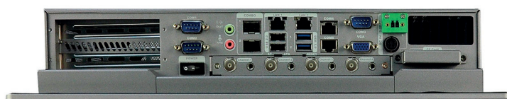
Рис. 2. На задней панели PPC-5152-D525 расположены интерфейсы ввода/вывода, способные удовлетворить любых пользователей.
