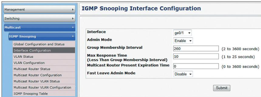
Рис. 6. Отслеживание трафика IGMP: веб-конфигурация.
