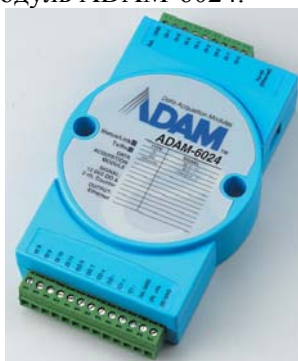
рис 5. Контроллер модульного исполнения - ADAM 6024
