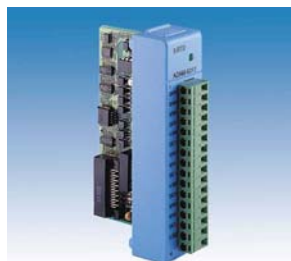
рис. 4. Типичный вид встраиваемых модулей серии ADAM-5000 - модуль аналогового ввода ADAM-5013
