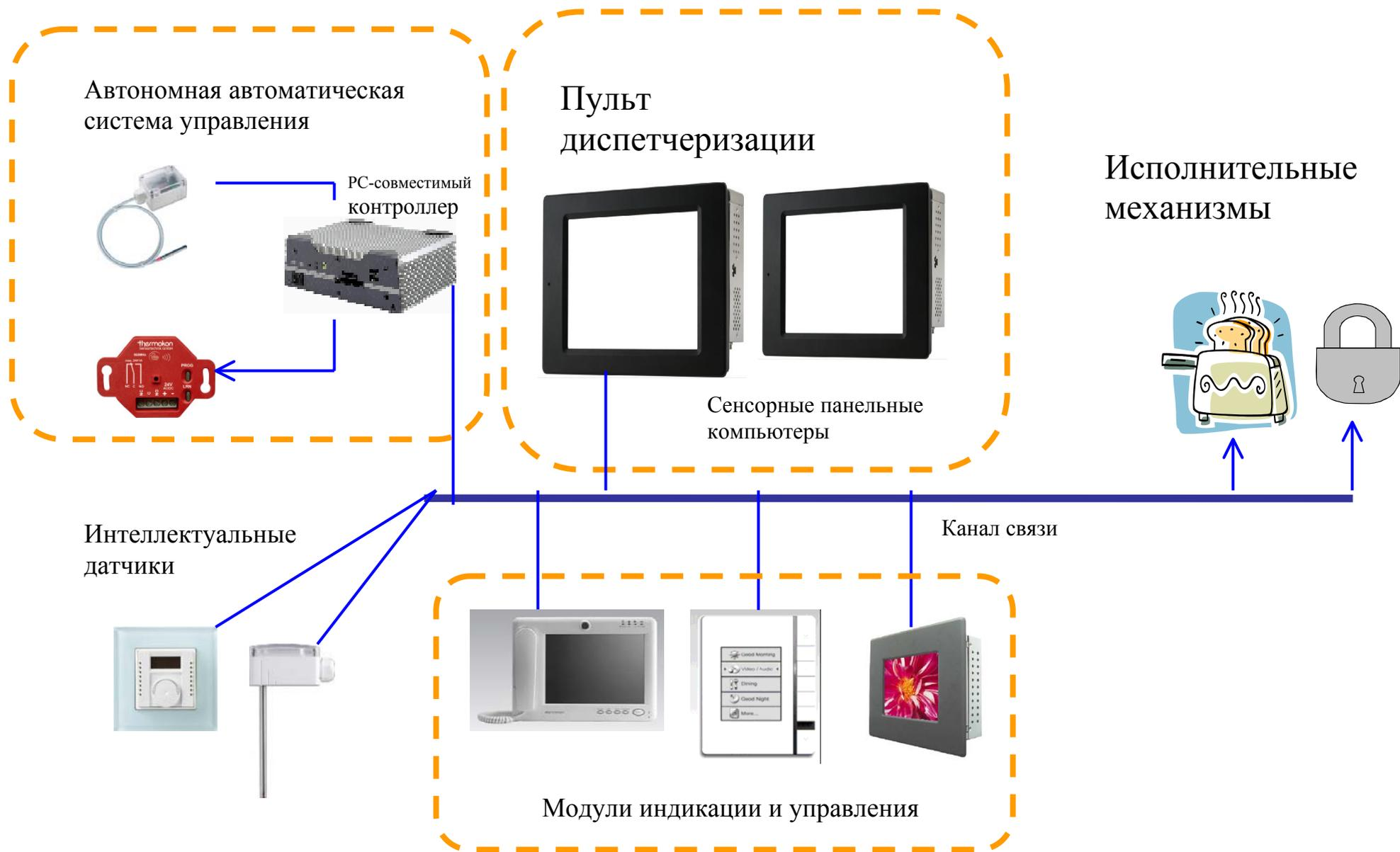
Рисунок 1. «Умная дача» в разрезе. Магистральный канал связи построен на фиброоптике, подключение модулей по интерфейсу RS-485.
