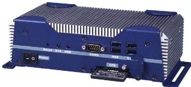
Рис.1. AEC-6810. Бюджетный контроллер на процессоре VIA Eden 667 МГц 4COM/4USB/TV-out
