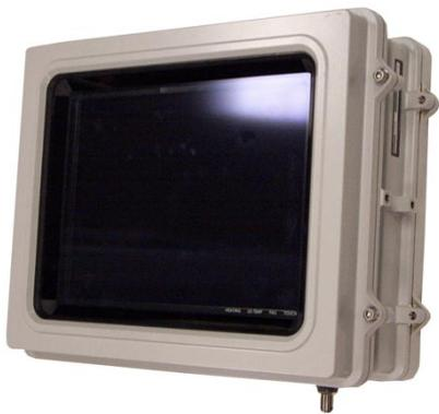
**Рис.2. Дисплей Kontron Triton Z2** оснащен 1,6-гигагерцовым процессором Intel Pentium M, высококачественным сенсорным экраном с диагональю 15 дюймов, имеет ОЗУ объемом до 512 Мбайт и может эксплуатироваться во взрывоопасных средах.
