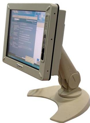
**Рис.3. «Нефтегазовая» взрывозащищенная рабочая станция Kontron Barracuda WS**, построенная на базе процессора Intel Pentium M с частотой 1,8 ГГц. Объем ОЗУ может достигать 1 Гбайт, поддерживаются накопители CompactFlash и 2,5-дюймовые жесткие диски. Продукт оснащен ярким сенсорным экраном резистивного типа и имеет все необходимые PC-интерфейсы.
