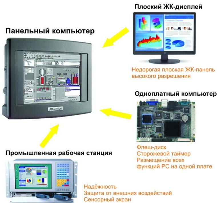
Рис.1 Технологические корни панельного компьютера
