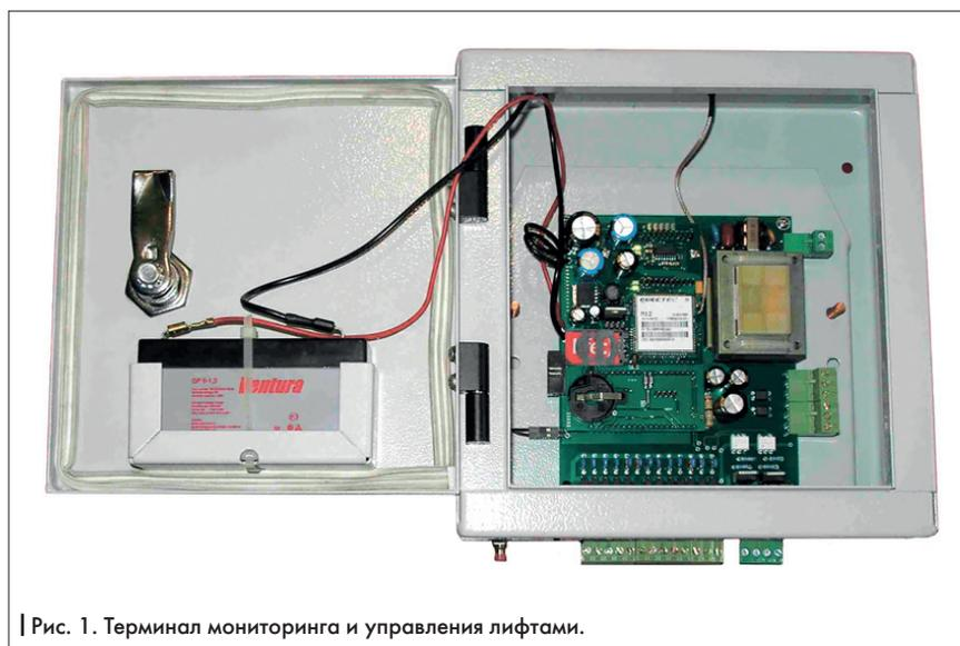
Рис. 1. Терминал мониторинга и управления лифтами.
