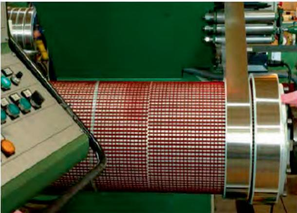
Фото 1. Автоматизированная линия по намотке обмоток ВН
