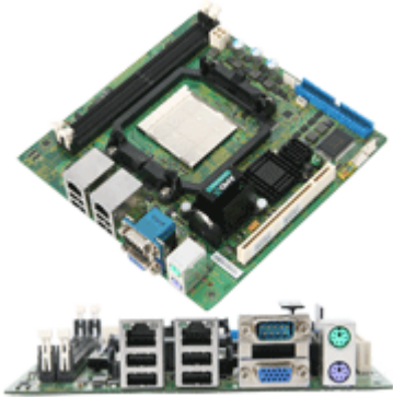
Рис.2 MS-9804 – яркий пример производительной энергоэффективной платы для мультимедийных платформ.
