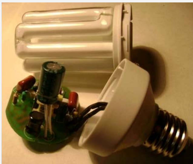
рис. 3 разработка СЭА Электроникс - ЭПРА под колбу КЛЛ мощностью 20Вт
