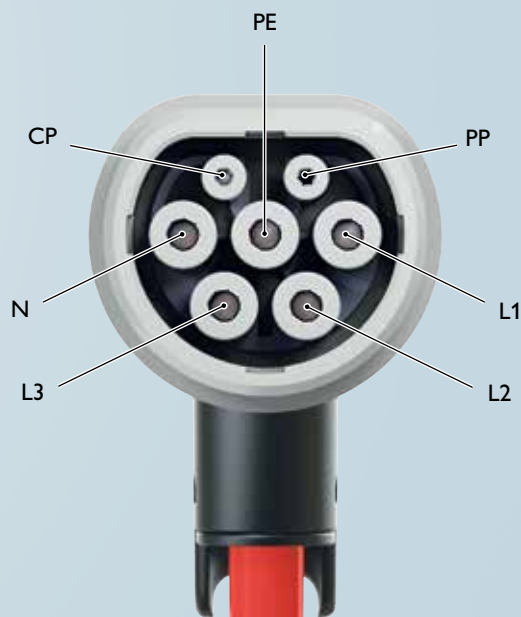
Штекер для заряджання від мережі змінного струму (AC) до гнізда на борту транспортного засобу, Тип 2
