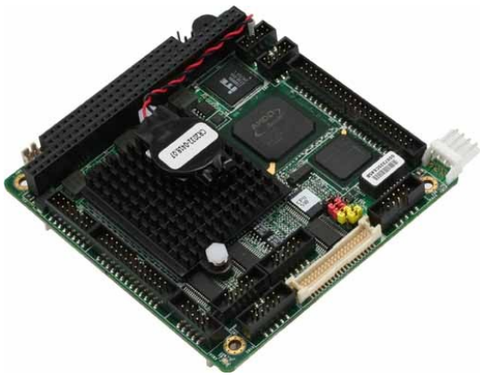
Рисунок 5. На одноплатном компьютере AAEON PFM-540I с размером платы 90 x 96 мм может работать Windows XP
