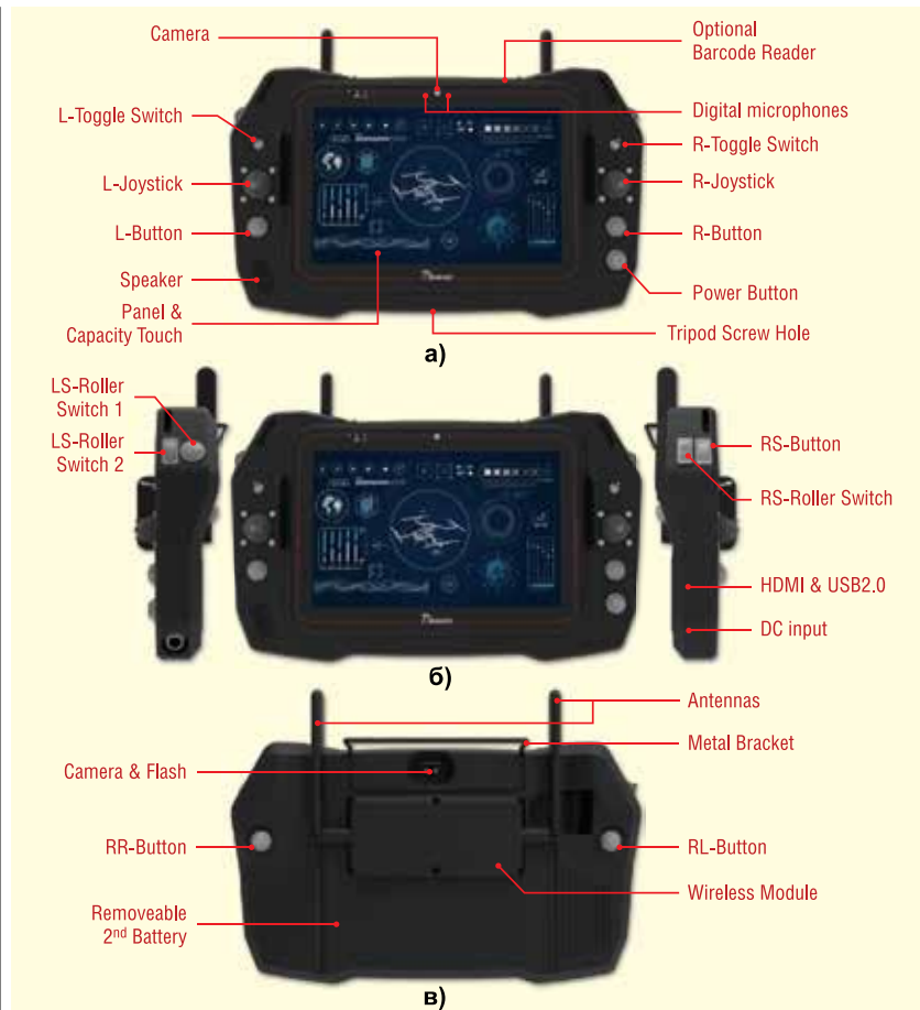
Рис. 10. Опис елементів портативної станції керування
