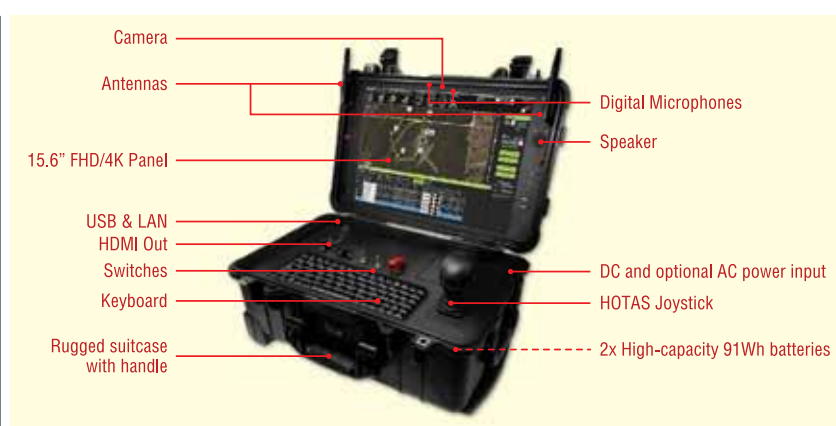
Рис. 11. Опис елементів наземної станції керування
