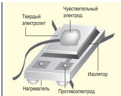
**Рисунок 5** Электрохимический датчик на основе твердотельного электролита
