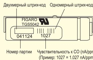
**Рисунок 3** Маркировка TGS5042
