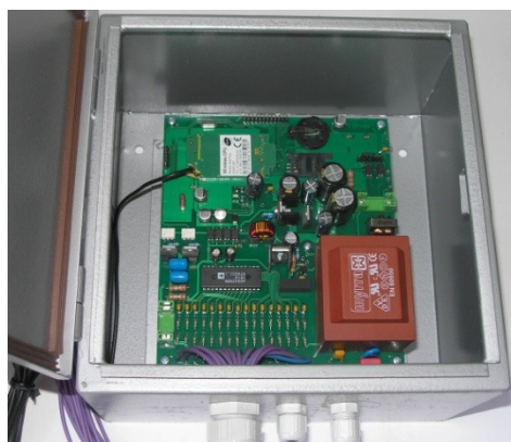
Рис.2 Терминал контроля и управления уличного освещения
