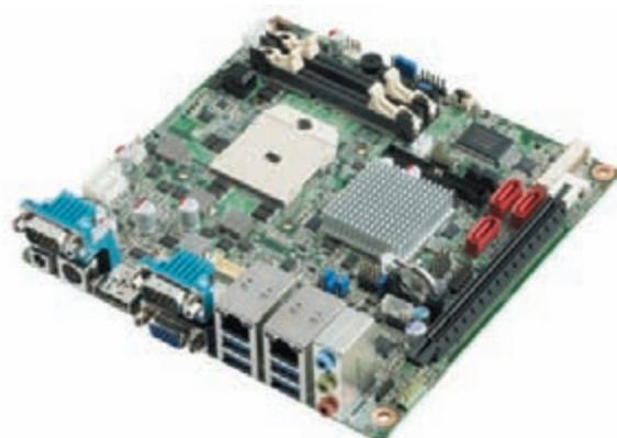
отличительной особенностью данной материнской платы является наличие высокоскоростных интерфейсов ввода/вывода, к которым относятся четыре порта USB 3.0 и два последовательных порта (на задней панели), два слота mini PCIe и один слот PCIe/mSATA, порт ввода/вывода общего назначения GPIO (8 бит) и интерфейс аудио HD.
