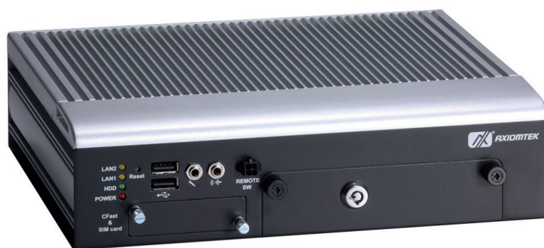
Рис. 1. Транспортный бокс-компьютер tBOX323-835-FL на недорогом 4-ядерном процессоре.
