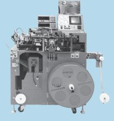
LED Mapping Probe Tester
