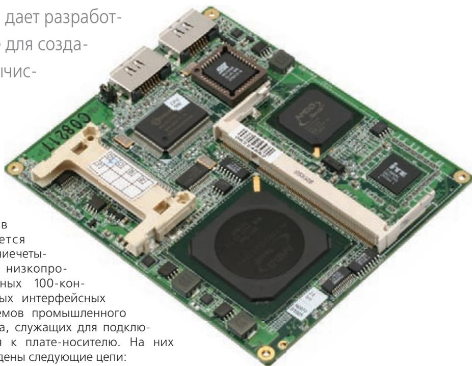
Рис. 1. ETX-701 «компьютер-на-модуле» для бюджетных малопотребляющих устройств
