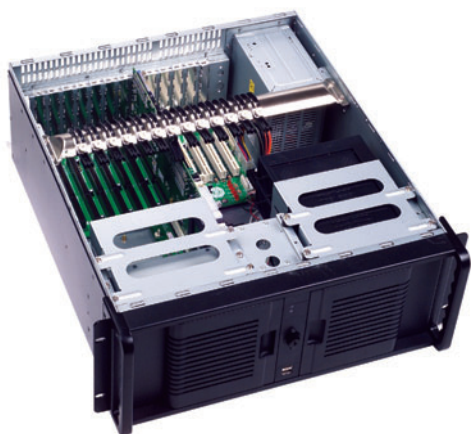
Рис. 1. Промышленный компьютер в стойке с высотой 4U
