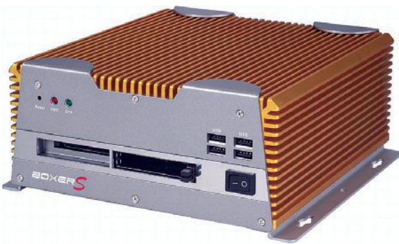
Рис. 5. Вохер AVR-3000 для видеонаблюдения и управления доступом
