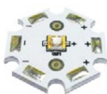
Плати (High Power LEDs) «зірка»
