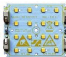
Плати (Mid power LEDs) другорядні
