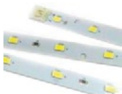
Плати 500мм (Mid power LEDs)
